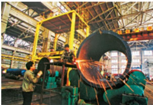
济南锅炉厂的员工在加工厚达 100 毫米以上的锅筒（2003 摄）
